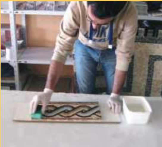
تنظيف سطح اللوحة الفسيفسائية من جميع الرواسب بواسطة إسفنجة وماء.
