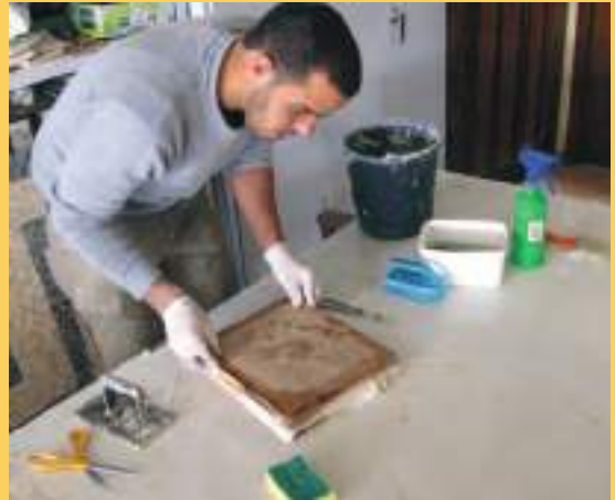
بعد الانتهاء من وضع المونة ( الخليط ) على اللوحة والاطار الخشبي ، وبعد عدة دقائق يتم قلب الاطار الخشبي وبداخله المونة ( الخليط ) على اللوحة الفسيفسائية.
