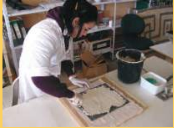
صب أول طبقة من المونه اللاصقة فوق لوحة الفسيفساء.
